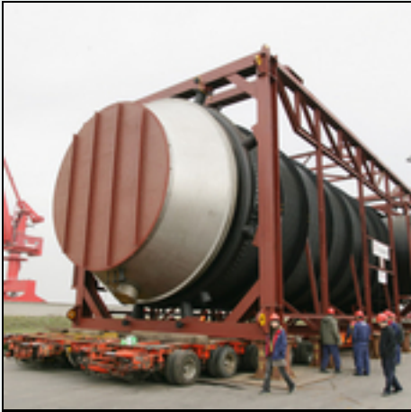
Transport eines Oschatz-Wasserrohrkessels zum Hafen von Nanjing
