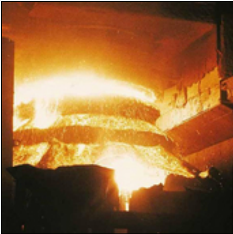
Oschatz-Konverter-Abgaskühlanlage mit heb- und senkbarem Stelling in Betrieb hinter LD-Konverter
